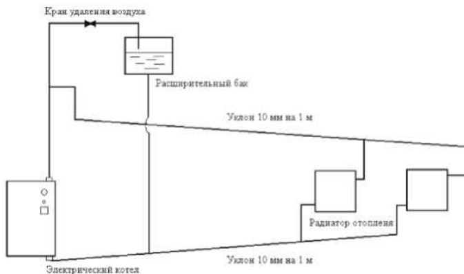
Рис. 4 - Установка электрического котла с открытой системой отопления
